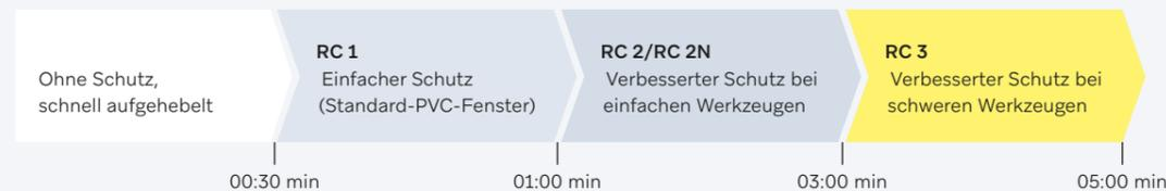
WERU Fenster bieten Ihnen optimalen Einbruchschutz – abgestimmt auf Ihre Bedürfnisse. Je höher die Schutzklasse, desto länger hält ein Fenster einem Einbruchversuch stand.
