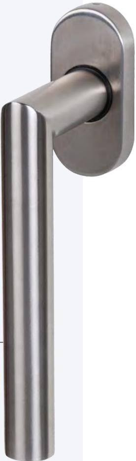
Die Secustik®-Fenstergriffe beinhalten einen patentierten Sperr-Mechanismus als integrierte Basis-Sicherheit. Er erlaubt zwar die normale Betätigung des Fenstergriffs von innen, blockiert aber den Griff, falls jemand versucht, den Fenstergriff von außen über den Beschlag zu manipulieren.
